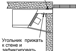
Герметизировать пенополиуретаном по всему периметру
