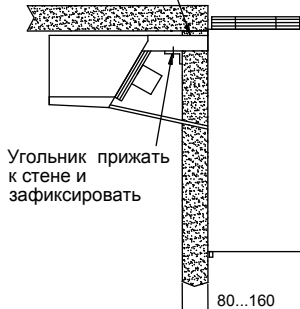
Герметизировать пенополиуретаном по всему периметру
